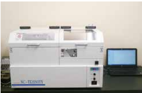
たんぱく質分析 燃焼法 全窒素・全炭素測定装置 (SUMIGRAPH NC-TRINITY)
